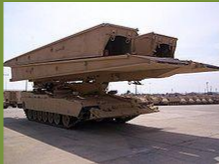
Obrázek 12: Americký mostní tank M104 Wolverine na podvozku tanku M1 Abrams
