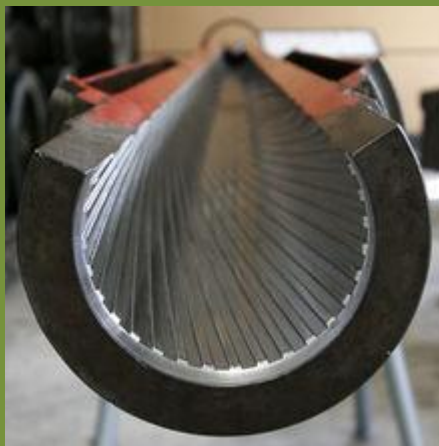
Obrázek 4: Řez kanonem ráže 105 mm
