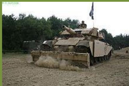
Obrázek 11: Britský ženijní tank Centurion Mk5 AVRE na podvozku tanku Centurion
