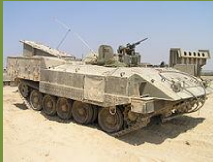
Obrázek 15: Izraelský těžký obrněný transportér Achzarit na podvozku tanku T-55
