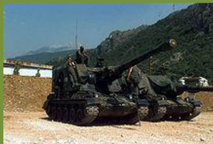
Obrázek 16: Francouzská 155 mm samohybná houfnice GCT na podvozku tanku AMX30
