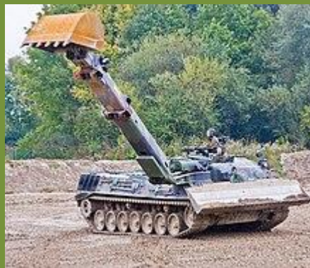
Obrázek 14: Německý ženijní tank Pionierpanzer 2 DACHS na podvozku tanku Leopard 1
