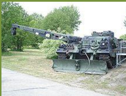
Obrázek 13: Německý vyprošťovací tank Büffel na podvozku tanku Leopard 2
